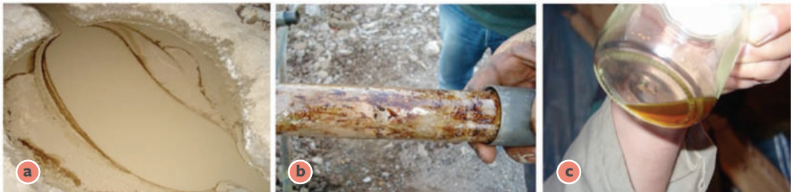
Resim 3.7.3: Konya-Niğde Neojen Havzasında Yapılan Çalışmalarda A) Sondaj Çamuru ile Birlikte Çıkan Petrol, B) Petrolü Karot Örneği, C) Kimyasal Eritici ile Çözündürülmüş Petrol
