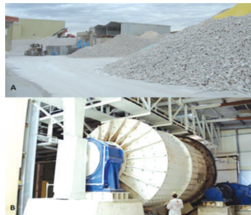
Resim 3.7.1: Niğde Kalsit İşletmelerinden İşlenmek Üzere Bekleyen Ham Kalsit (A) ve Kalsit Öğütme Sistemi (B)
